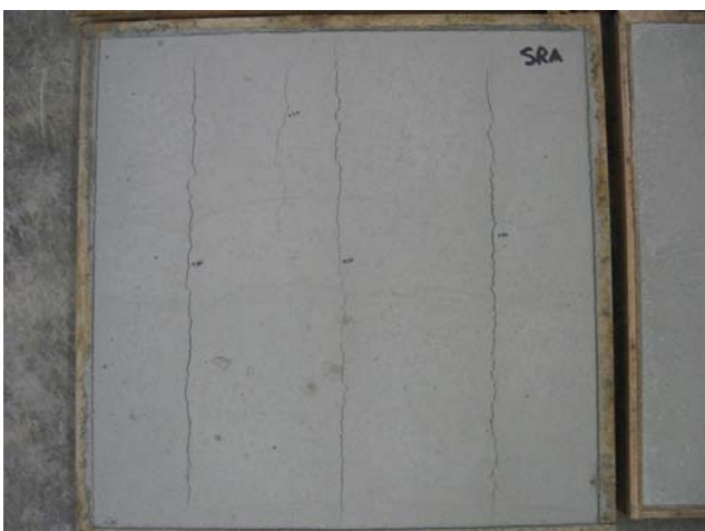
写真-9 SRA 配合のひび割れ発生状況
