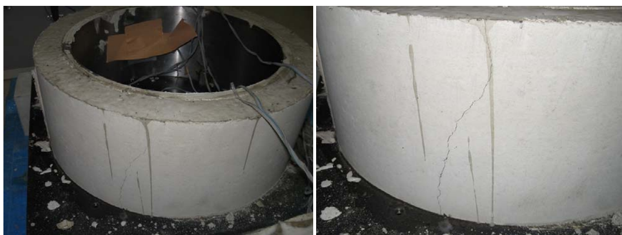
写真-5 Fiber 配合のひび割れ状況
