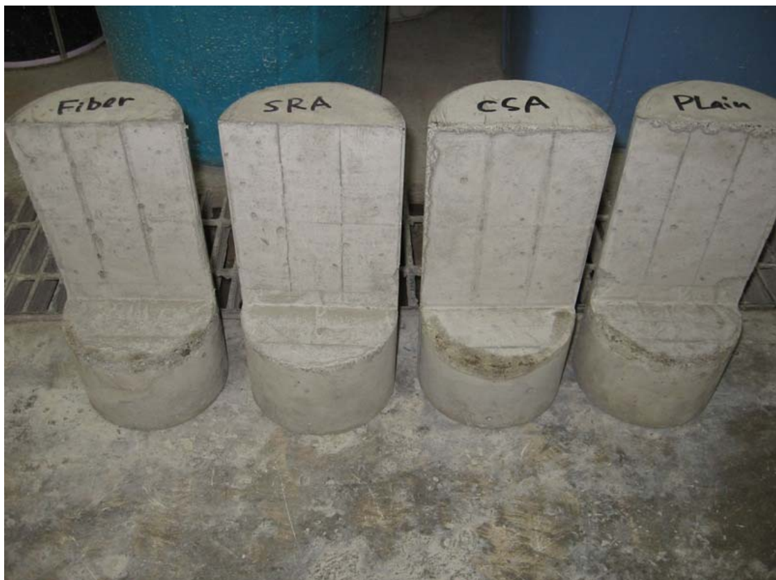
写真-2 沈下ひび割れ試験 脱型後の状況 (全配合)
