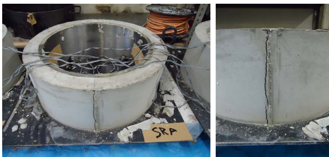
写真-4 SRA 配合のひび割れ状況
