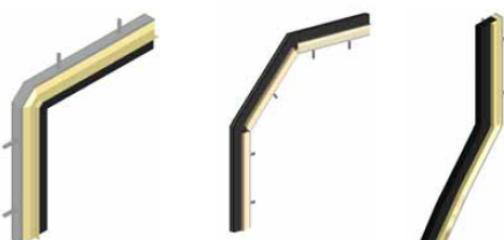
面取(L型)加工    ハンチ加工    R加工
